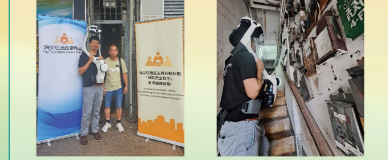
「三維空間(3D)建築繪圖先導計劃」為其中一幢位於大角咀的目標大廈提供大廈掃描及3D繪圖服務 工作人員利用掃描器掃描目標大廈的公用地方
